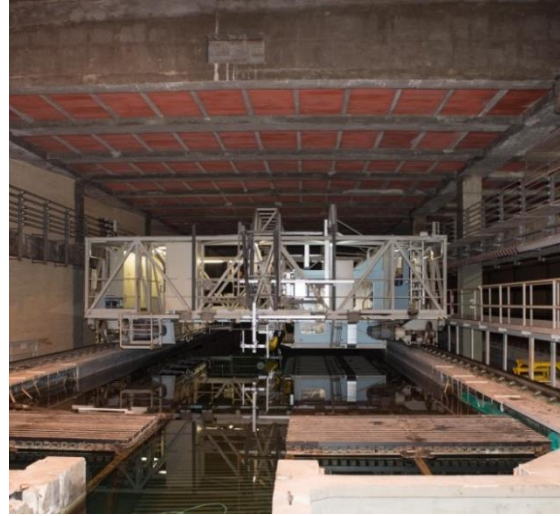
Sinistra: Massima posizione raggiunta dal carro ponte rispetto alla struttura; Destra: Carro dinamometrico che può essere utilizzato come struttura di supporto per sistemi di sollevamento.
