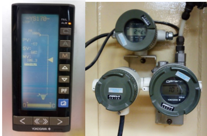
Figura 11. Dispositivo per la regolazione della pressione nell'impianto (sinistra) e sensori per la misura della pressione in camera di prova e della temperatura dell'acqua (destra)
