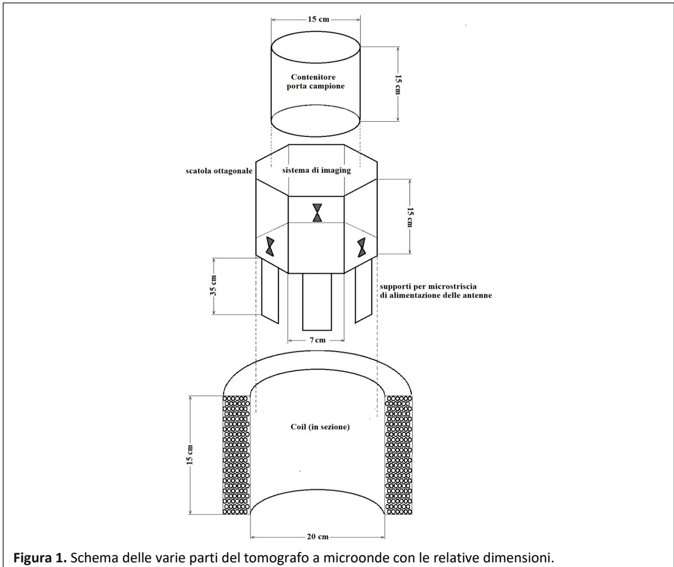
Figura 1. Schema delle varie parti del tomografo a microonde con le relative dimensioni.
