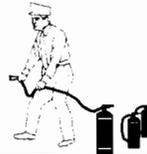
Olio e benzina accesi, situati in contenitori aperti, non vanno mai spenti usando l'estintore dall'alto, ma orientando il getto dell'estintore sul bordo del contenitore, cercando di rompere la fiamma per permettere il soffocamento dell'incendio.
