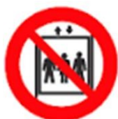
NON ADOPERARE GLI ASCENSORI IN CASO DI INCENDIO
